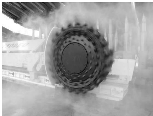
Rys. 4. Kombajn ścianowy KSW-1500EU firmy KOPEX Machinery S.A. wyposażony w kurtynę powietrzno-wodną [14]
