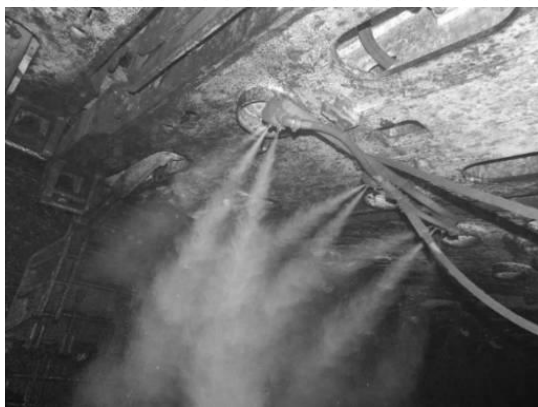
Rys. 5. Zasięg teoretyczny oraz praktyczny strumieni zraszających systemu KOMAG [16]
