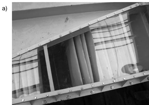
Rys. 19. Widok od góry przestrzeni komory wlotowej odpylacza suchego z filtrami workowymi: a) przed próbą; b) po próbie [13]
